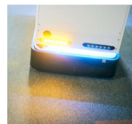
写真2 ウィンカー 音声案内、ウィンカー、衝突防止、緊急停止
