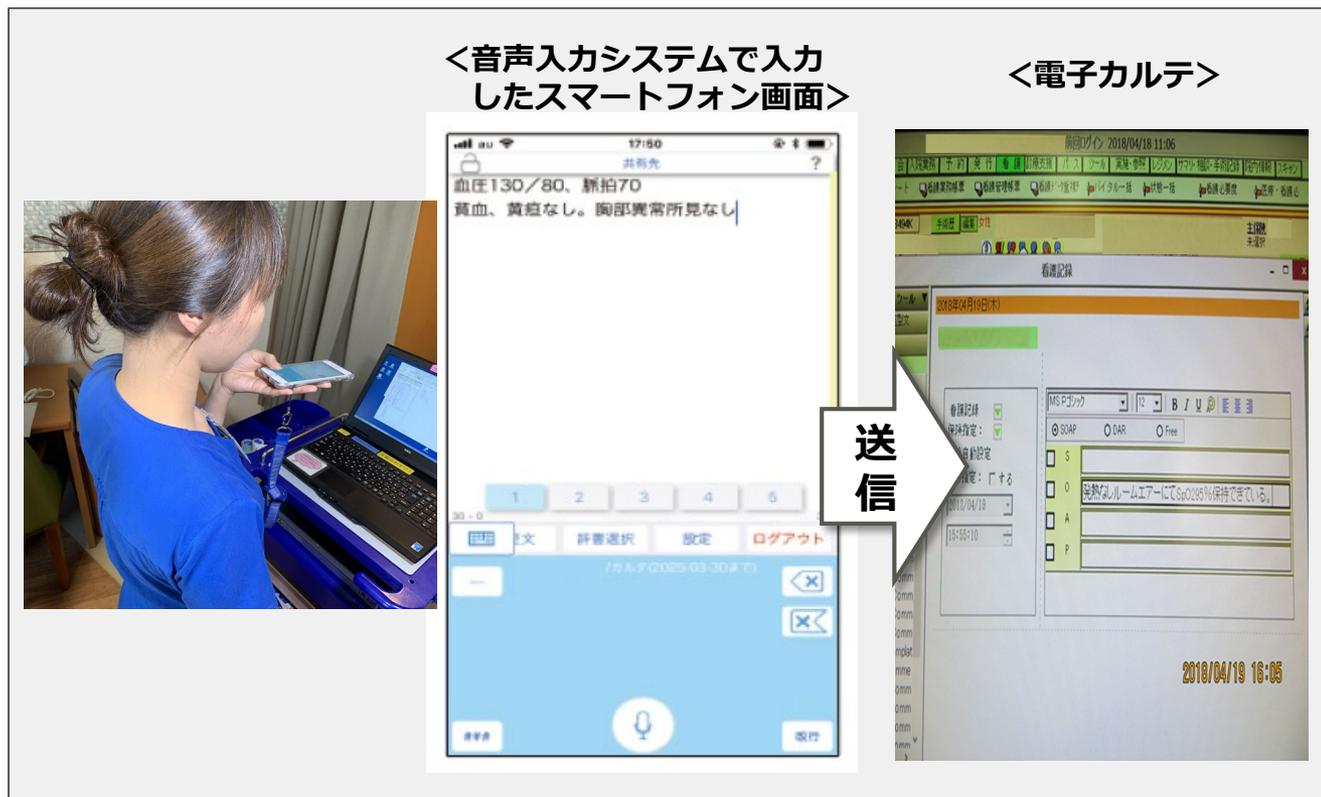
【技術評価】 音声入力約270文字/分は、タイピング速度60文字/分の約4.5倍の速度向上
